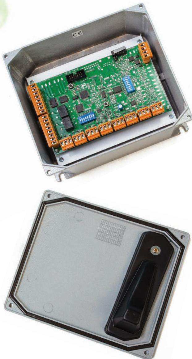
Il satellite **FC14** costituisce una delle possibili espansioni su BUS di edificio per le centrali PB. È dotato di 8 ingressi, di 2 uscite relè e di 6 uscite Open Collector disponibili in morsettiera.
