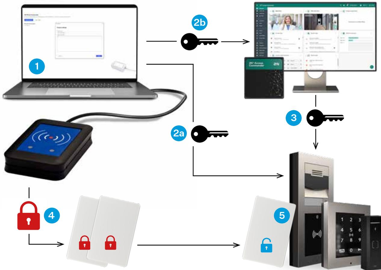
Al centro dell'intera soluzione c'è **2N® PICard Commander**, un'applicazione software che consente agli amministratori di creare un keyset crittografico unico per ogni complesso **1**. I keyset si basano sulla **chiave di crittografia principale (MEK)**, da cui derivano le chiavi di crittografia per la codifica delle credenziali e le chiavi di lettura.
