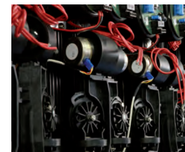
I componenti dei raggi trasmettitori e ricevitori sono montati su di una meccanica ad orientamento micrometrico che permette un'escursione di 190° in orizzontale e di 15° in verticale.
